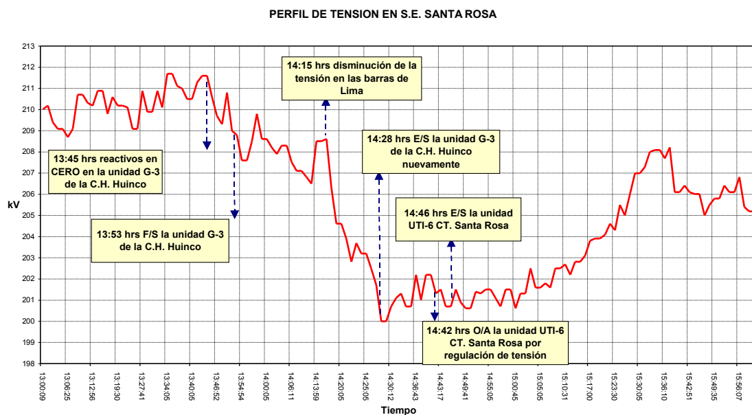
Comportamiento de la tensión en las barras de 220 kV de la S.E. Santa Rosa
